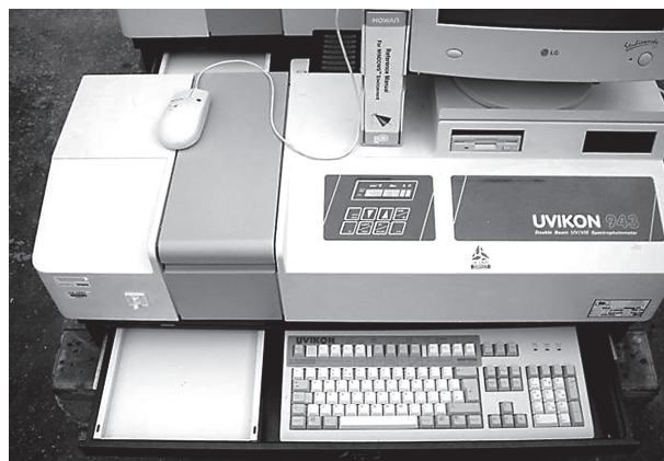
Рис. 1. Двухлучевой спектрофотометр Uvikon 943 (Kontron Just, США).
