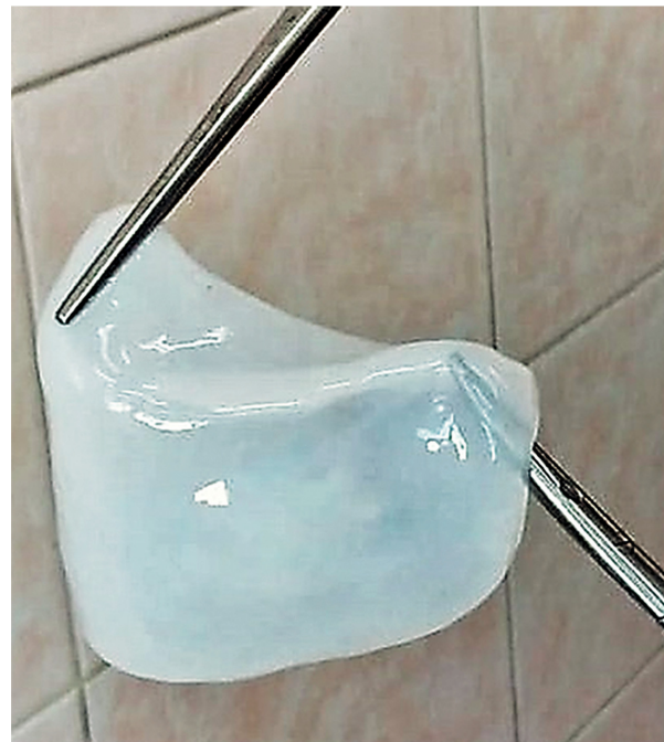
Рисунок 1. Пластины влажной бактериальной целлюлозы (ИПХЭТ СО РАН, г. Бийск).
